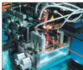
[1] Сервоприводы DriveLine обеспечивают при оперативной смене продукции на окантовочном прессе постоянство качества продукции.
