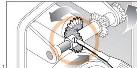
Если в зацеплении находится левое зубчатое колесо [1], то получается положительное направление счета по часовой стрелке; если в зацеплении находится правое зубчатое колесо [2], то получается положительное направление счета против часовой стрелки. Здесь представлено направление взгляда снизу.
