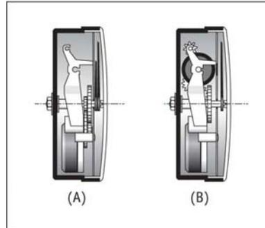
Схематическое устройство аналогового (А) и цифрового (В) индикаторов. Маленькие грузы обеспечивают в этом примере вертикальное положение индикации.
