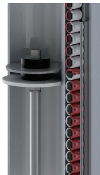
Труба, устанавливаемая сверху, имеет магнитную систему, которая соединяется с поплавком и передающим стержнем. Концентрированное магнитное поле постоянного магнита передает значения уровня жидкости в резервуаре, пропорциональное высоте заполнения, бесконтактным методом по стенкам вертикальной трубы на установленные снаружи элементы отображения, записи и переключения.
